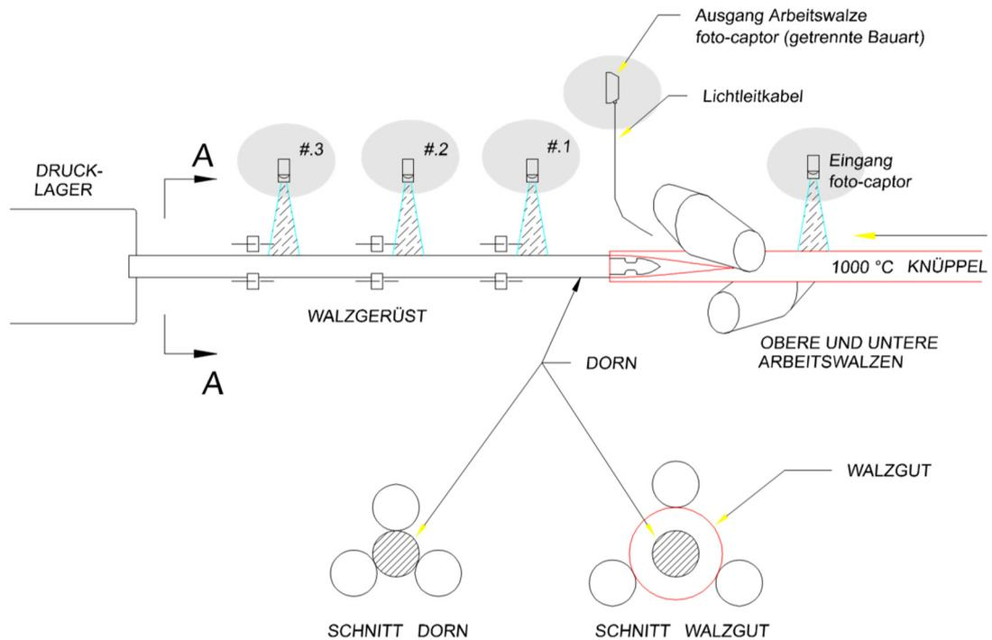
**PROBLEM** Bei der Herstellung von nahtlosen Rohren muss eine Materialverfolgung durchgeführt werden, um einen sanften (glatten) automatischen Herstellungsprozess zu gewährleisten.
