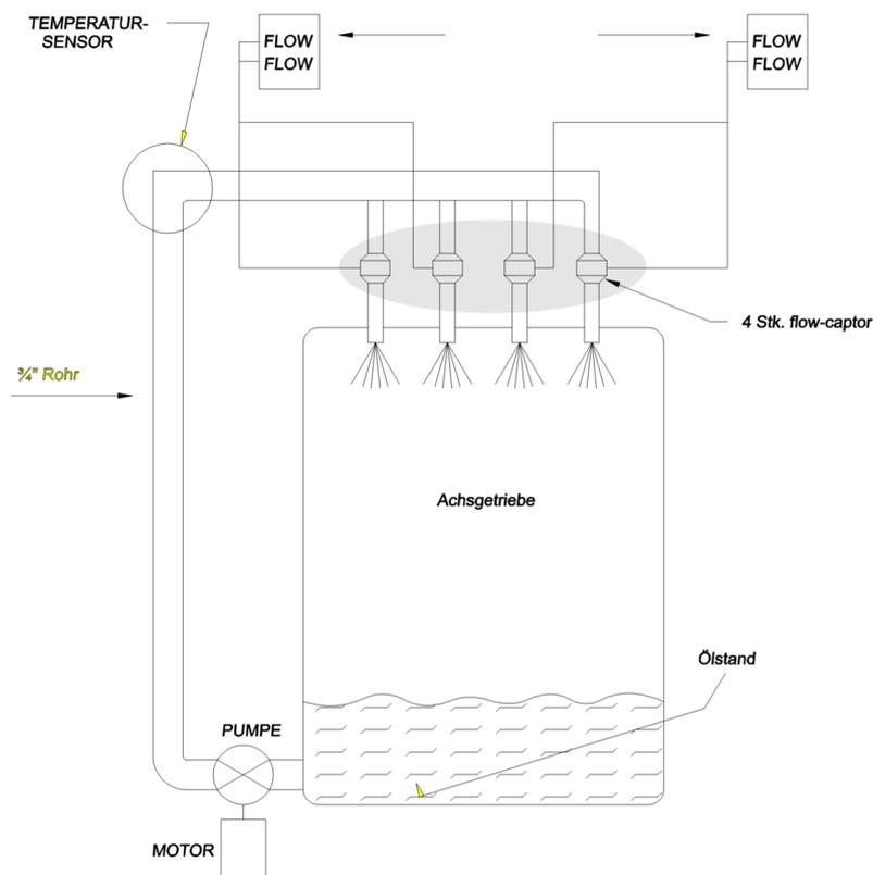
**PROBLEM** Ein Schmiermittelsystem hat sicherzustellen, dass das Schmiermittel an alle Teile der Maschine gelangt. Es kann passieren, dass z.B. der Ölfluss zu dem Getriebe durch Leitungsunterbrechungen, Lecks oder Ähnliches unterbrochen wird.
